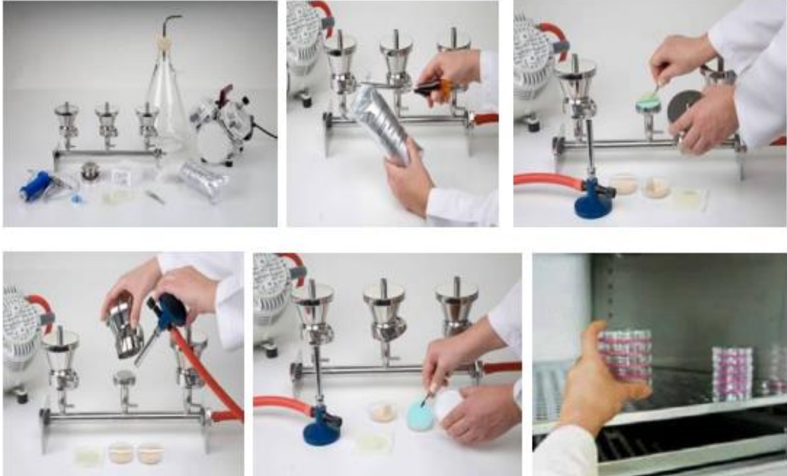
Şekil 1. Membran filtre yönteminin uygulanması
