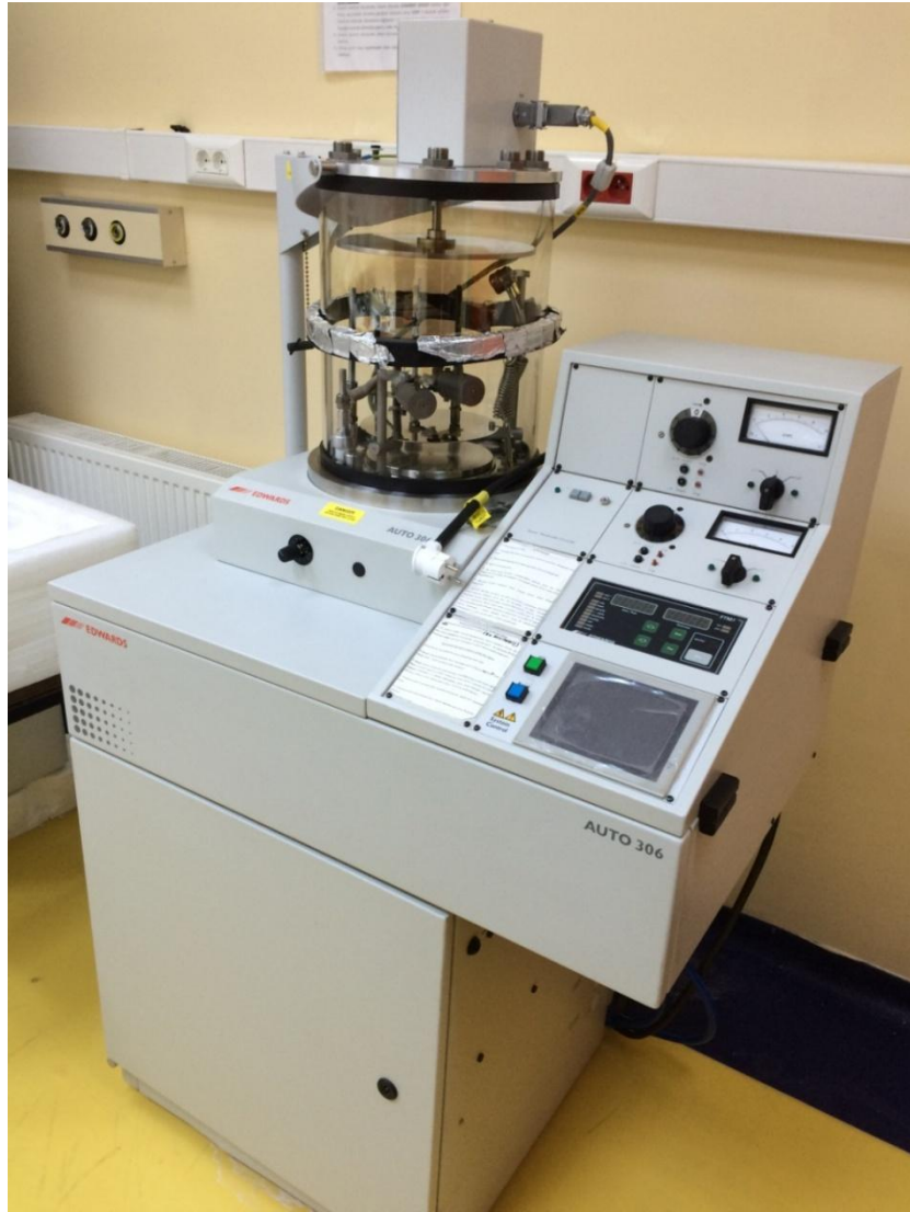
Şekil 4.1. Deneylerde kullanılan vakum kaplama sistemi
