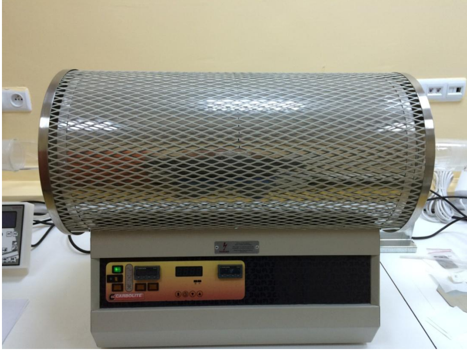
Şekil 4.2. Tavlama için kullanılan fırın
