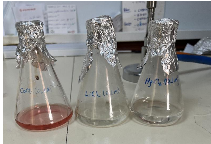
Şekil 3.1 Soldan sağa doğru sırasıyla Kobalt ( \text{CoCl}_3 ), Lityum ( \text{LiCl} ) ve Civa ( \text{HgCl}_2 ) stok solüsyonları
