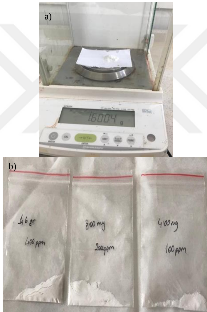
Şekil 3.3. Uygulama öncesi hazırlanan farklı dozlarda nano silisyumlar. (a. Yapılan tartım, b. Hazırlanan nano silisyumlar).
