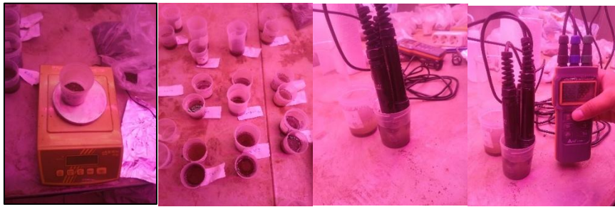
Şekil 3.8 pH ve EC toprak su karışımı
