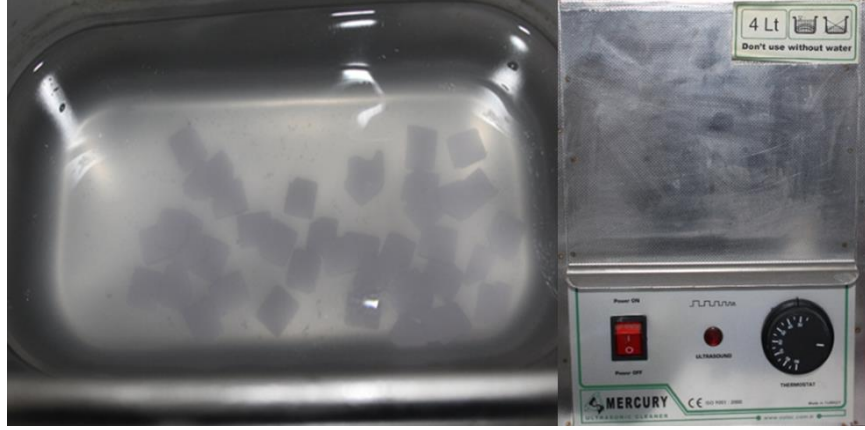
Şekil 23. Örneklerin Ultrasonik temizleme cihazı ile temizlenmesi (solda), Çalışmada kullanılan Ultrasonik temizleme cihazı(sağda)
