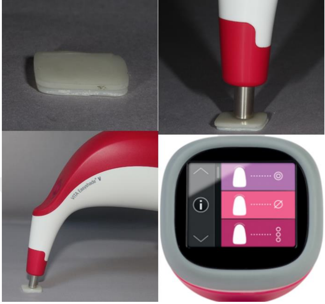
Şekil 31. Spektrofotometre ile renk ölçümü (sağ üst ve sol alt), Vita Easyshade 'in ekran görüntüsü (sağ alt), Polimerize edilmiş siman üzerindeki blok (sol üst)
