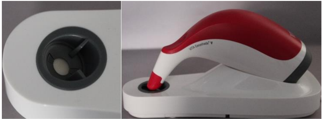
Şekil 32. Spektrofotometrenin kalibrasyon ünitesi (solda), kalibrasyon için spektrofotometrenin üniteye yerleştirilmesi (sağda)
