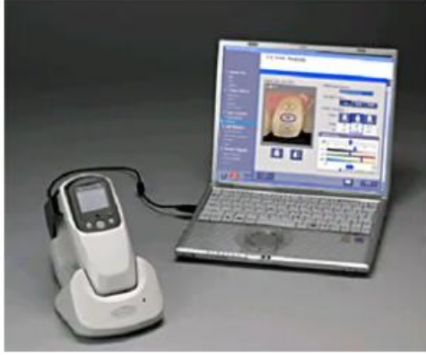
Şekil 14. Crystaleye spektrofotometresi (solda), cihazın ekran görüntüsü (sağda) (Chu ve ark., 2010)
