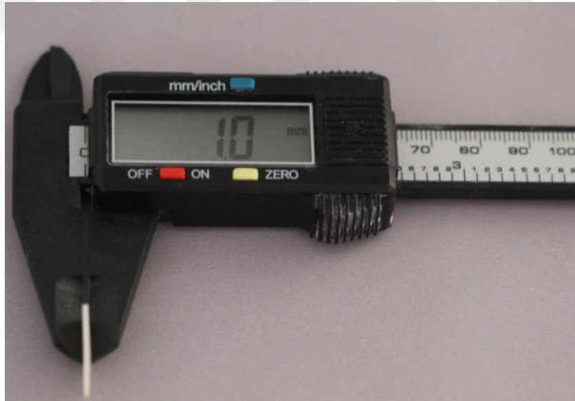
Şekil 22. Örneklerin kalınlık ölçümünün yapılması
