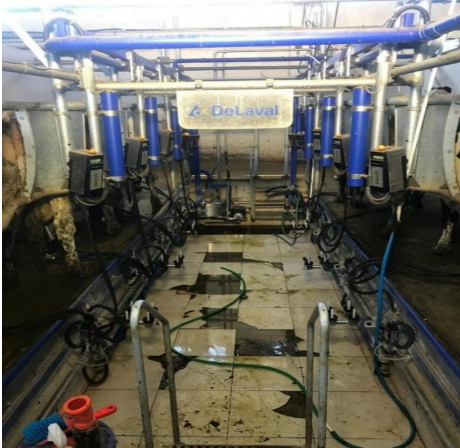
Şekil 3.2 İşletmede hayvanların sağıldığı balık kılçığı sistemi sağım ünitesi ve sağım çukuru
