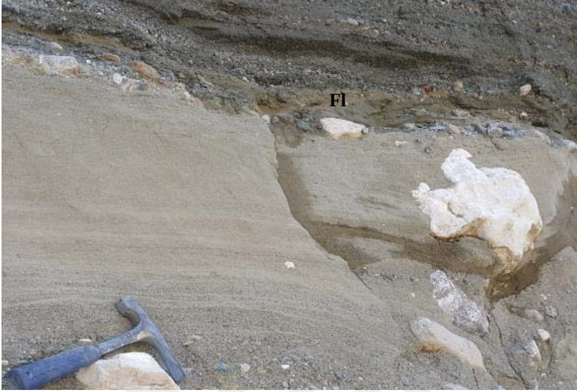
Şekil 4.17. Laminallı kum-silt-kıl fasiyesini (Fl) gösteren arazi fotoğrafı.
