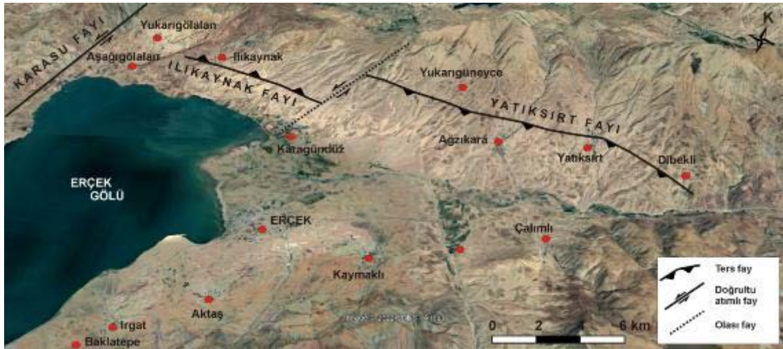
Şekil 4.31. Havza kuzeyinde yer alan Karasu, Ilıkaynak ve Yatıksirt faylarının Google Earth uydu görüntüsü üzerine işlenmiş konumları.
