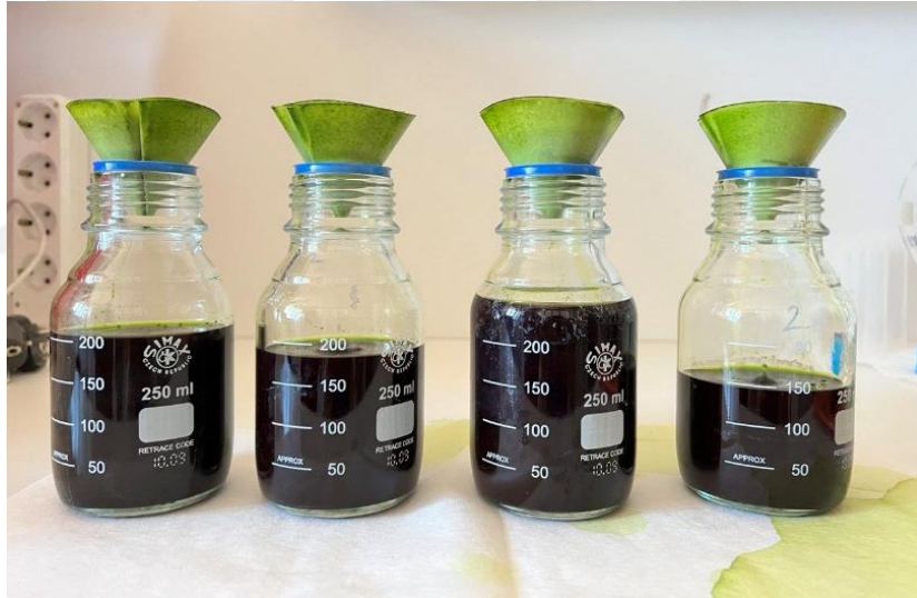
Şekil 3.5 Ceviz yeşil kabuğu özütünün filtre kâğıdından geçirilme aşaması.
