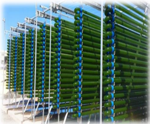
Şekil 2.13 Fotobiyoreaktörde kule ve sarmal üretim sistemi (Gezici, 2012)
