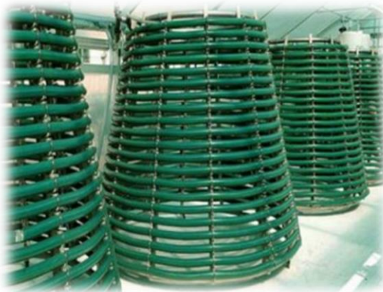
Şekil 2.13 Fotobiyoreaktörde kule ve sarmal üretim sistemi (Gezici, 2012)
