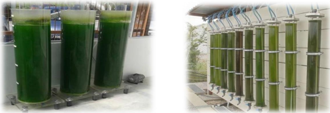
Şekil 2.16 Sütun (boru) fotobiyoreaktörler (Gezici, 2012)
