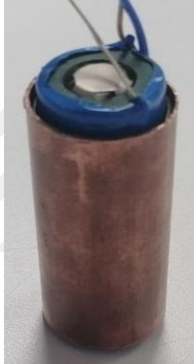
řekil 3.3 Deney odası ve termokupl yerleřimi
