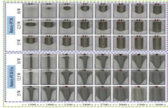
Şekil 2.8 FDM'nin farklı sistemlerde faz geçiş süreci (Fan vd., 2021)
