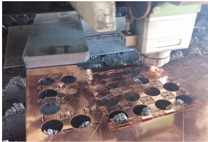
Şekil 3.6 Tasarlanan kanatçıkların lazer kesimi
