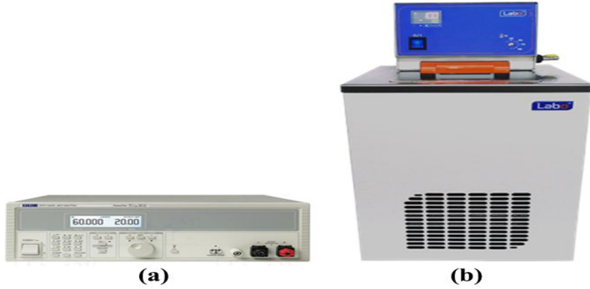
Şekil 3.2. Deneylerde kullanılan güç kaynağı (a) ve sıvı sirkülatörü (b).
