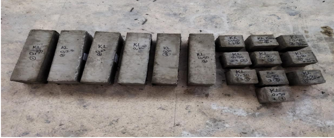
0.50 kenevir lif katkılı kiriş ve küp numuneler
