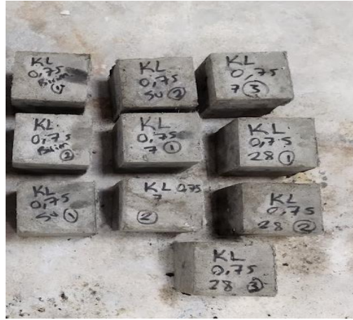
0.75 kenevir lif katkılı küp numuneler
