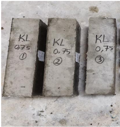
0.75 kenevir lif katkılı kiriş numuneler
