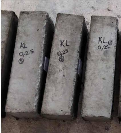
0.25 kenevir lif katkıli kiriş numuneler
