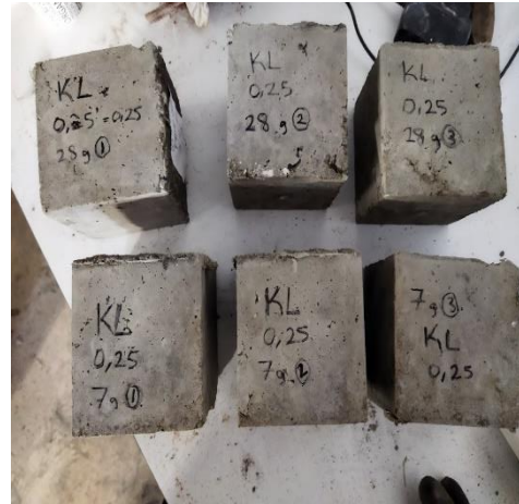
0.25 kenevir lif katkıli küp numuneler
